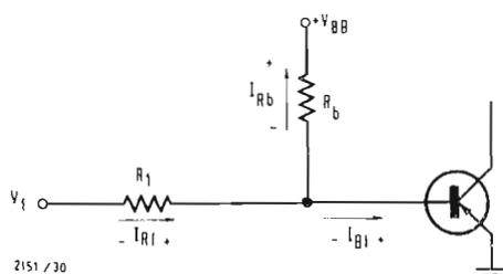
Fig. 17 - Circuito equivalente a quello di fig. 13 nello stato di conduzione.
