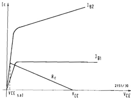
Fig. 21 - Per ricavare la tensione di saturazione del transistoro di fig. 20.
