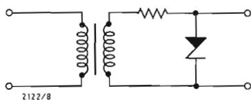
Fig. 1 - Principio del circuito limitatore con un diodo Zener di potenza.
