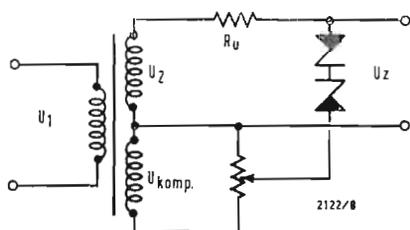
Fig. 7 - Principio del limitatore con avvolgimento di compensazione.
