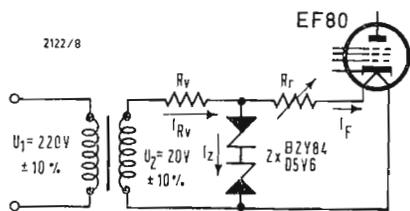
Fig. 3 - Principio della stabilizzazione della tensione di accensione con diodi Zener BZY 84/D5 V6, coi seguenti dati:
