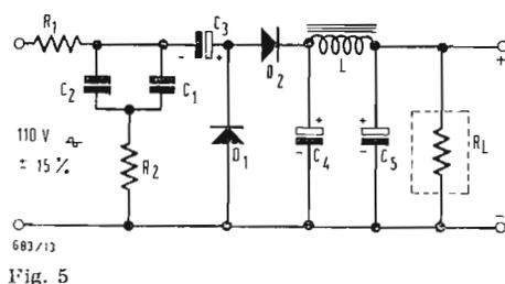
sione continua disponibile ai punti *DM* ai quali si connette l'amplificatore simboleggiato da  $R_L$ , è di 230 V. Si devono considerare due versioni: correnti fornite 250 mA e 360 mA (versioni A e B). I valori dei componenti dipendono dalla corrente fornita all'apparecchio  $R_L$ , cioè quella che attraversa la resistenza simbolica  $R_L$ . La tabella 1 dà i valori per ciascuna versione.
