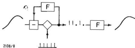
Fig. 3 - Diagramma funzionale di una giunzione con modulazione in delta. All'emissione un circuito realtivo « quantizzato » dà luogo a impulsi « 1 » e « 0 ». Per l'effetto di reazione, il segnale all'uscita del filtro *F* somiglia da vicino all'originale. Lo stesso filtro può essere applicato al ricevitore per convertire le serie di impulsi in un segnale di uguale approssimazione.
