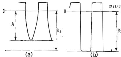
Fig. 2 - a) L'ampiezza negativa  $A$  della tensione alternata è minore della tensione di effetto Zener  $U_z$ , pertanto non viene tagliata. b) L'ampiezza negativa della tensione alternata supera la tensione di effetto Zener e viene perciò limitata.
