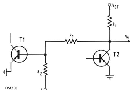
Fig. 3 - Bistabile che pilota il circuito n. 1 (e seguenti).
