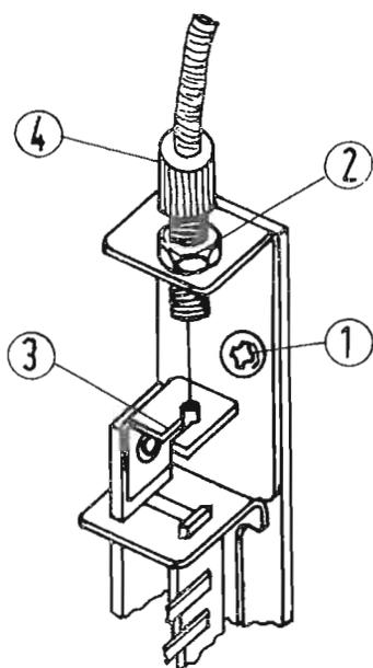
Fig. 3 - Particolari di smontaggio del comando flessibile.
