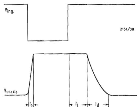
Fig. 1a - Impulso d'uscita di un transistor.
