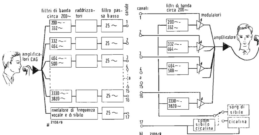
Fig. 8 - Schema di un sistema « Vocoder » (secondo Slaymaker).
