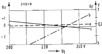
Fig. 4 - Dipendenza della frequenza dell'oscillatore dalla variazione della tensione di accensione. a) con diodi Zener; b) senza diodi Zener (+ 12,5%); c) senza diodi Zener (- 4,5%).
